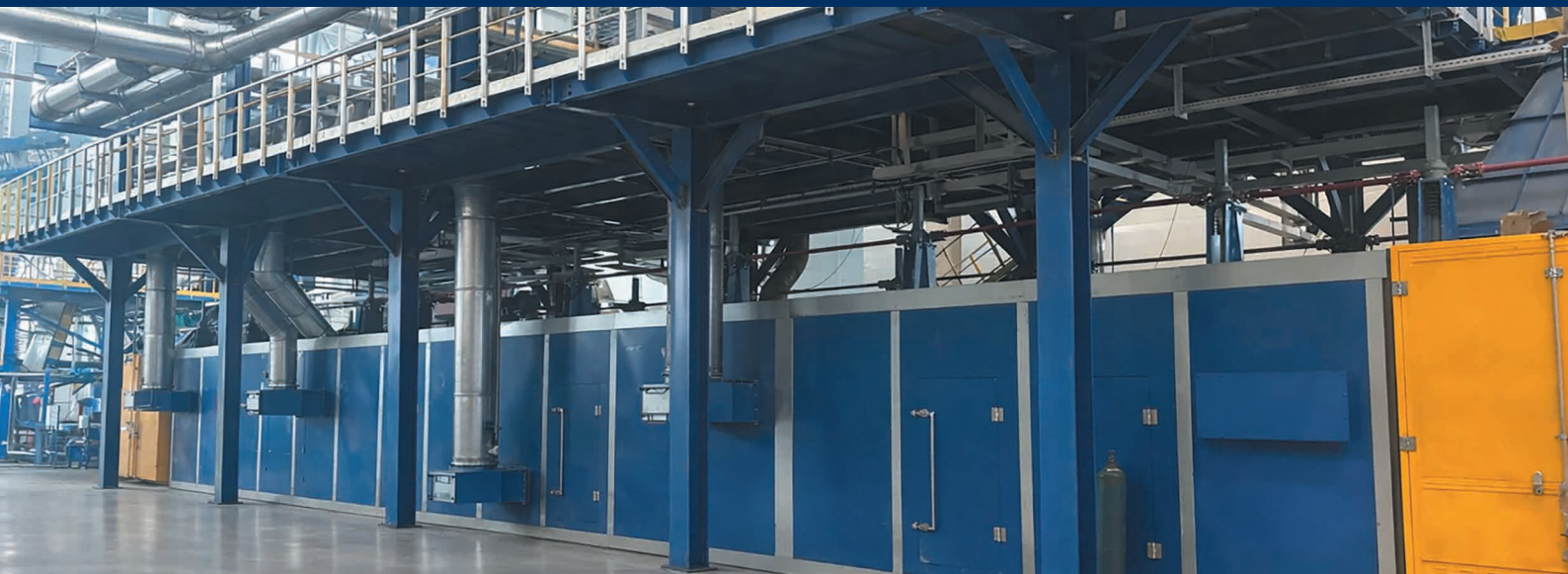
Завод теплоизоляционных материалов из минеральной ваты, линия минеральной ваты с камерой полимеризации
