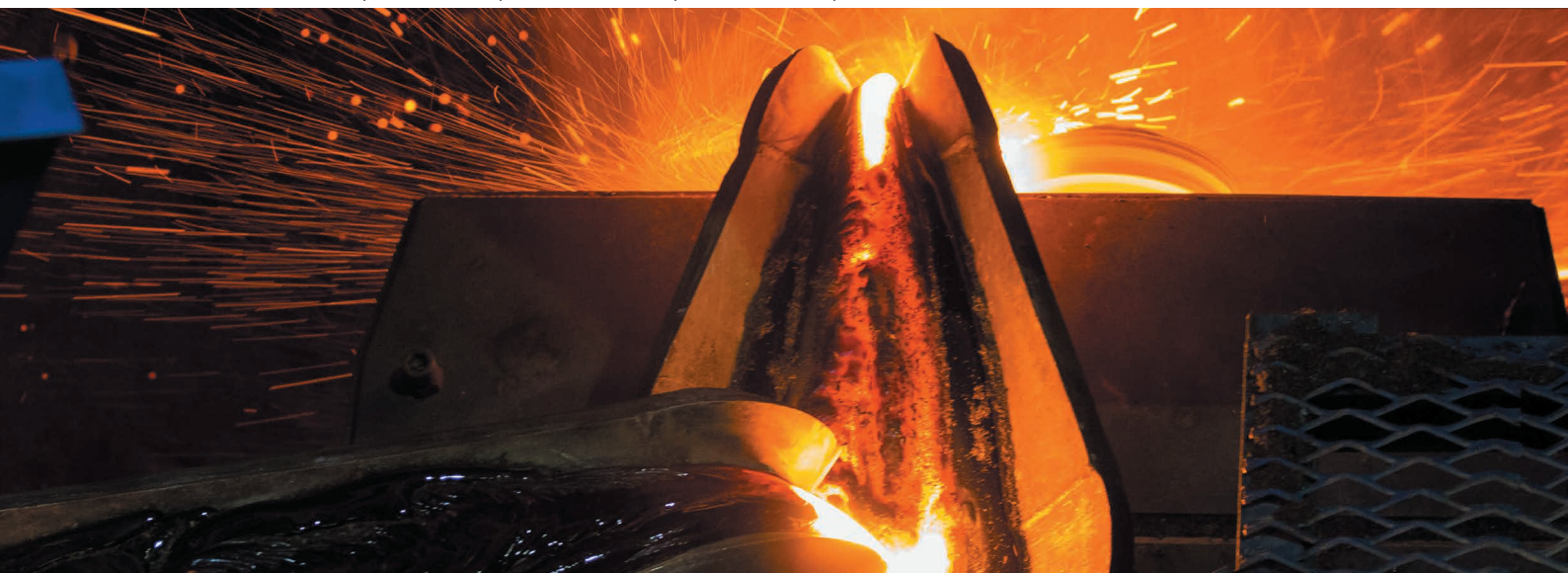
Завод теплоизоляционных материалов из минеральной ваты, участок подачи расплава на центрифугу
